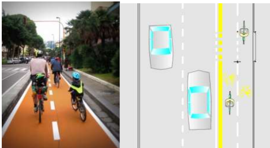
Figura 9: Immagine e schema di una pista ciclabile
