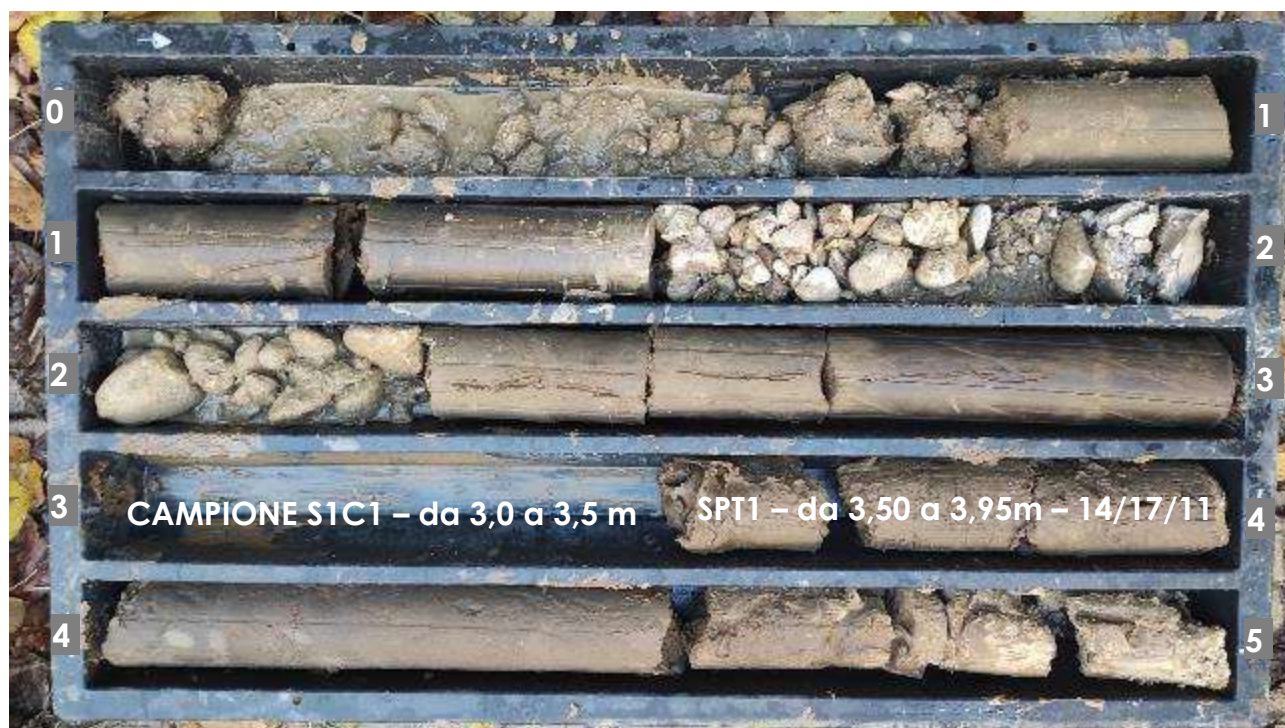
Foto cassetta catalogatrice n.1 Sondaggio geognostico S1 da 0 a 5 m dal p.c..
