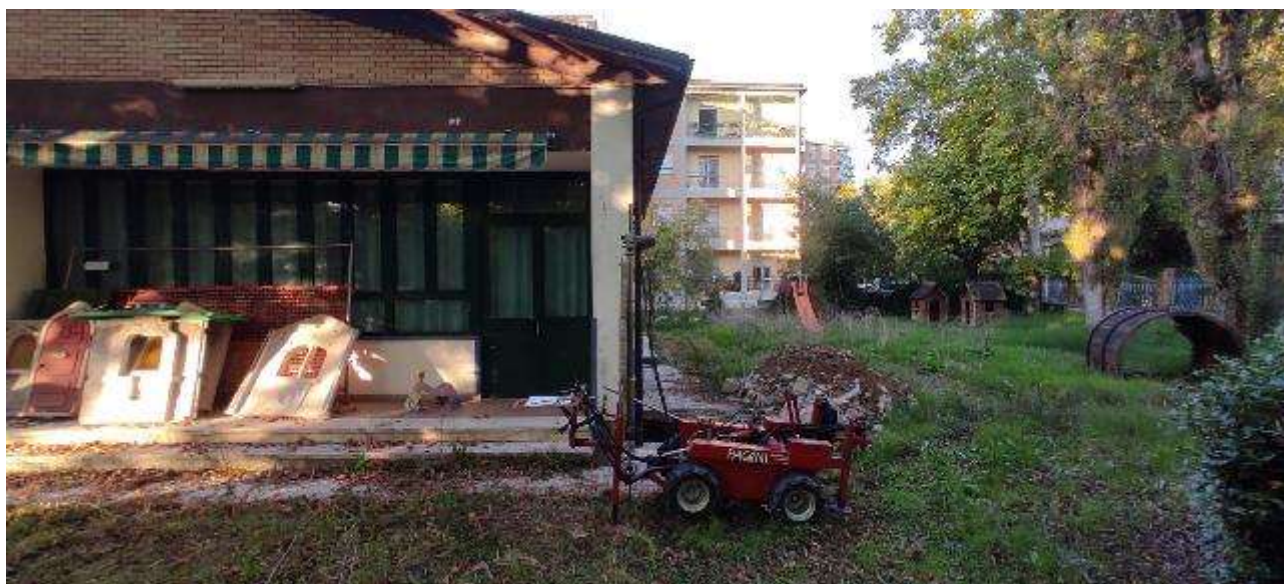
Foto 4. Esecuzione prova penetrometrica dinamica continua P4.
