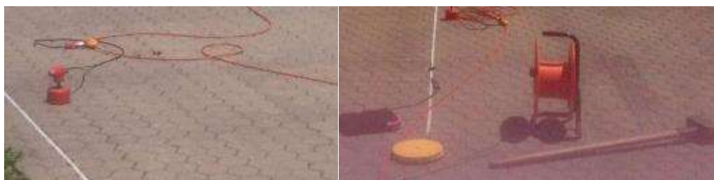
Figura 3 – Particolare del sensore ed accoppiamento col terreno e sistema energizzante.
