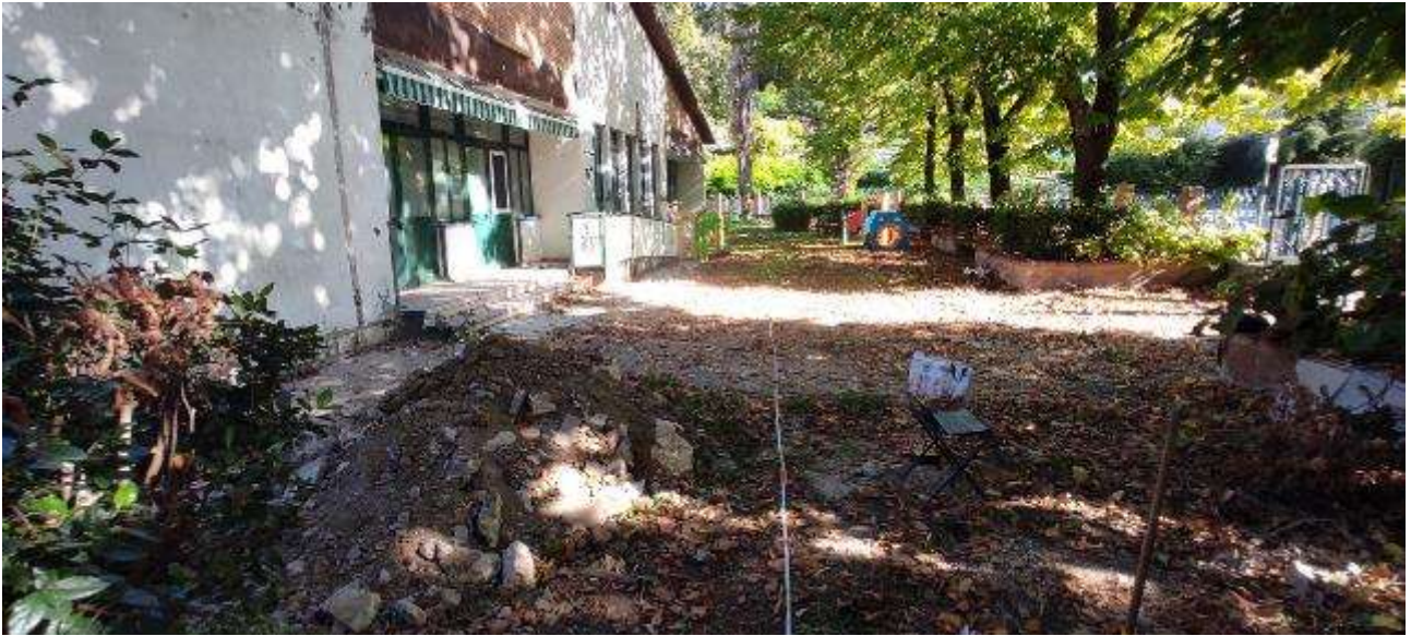
Foto esecuzione stendimento sismico MASW.
