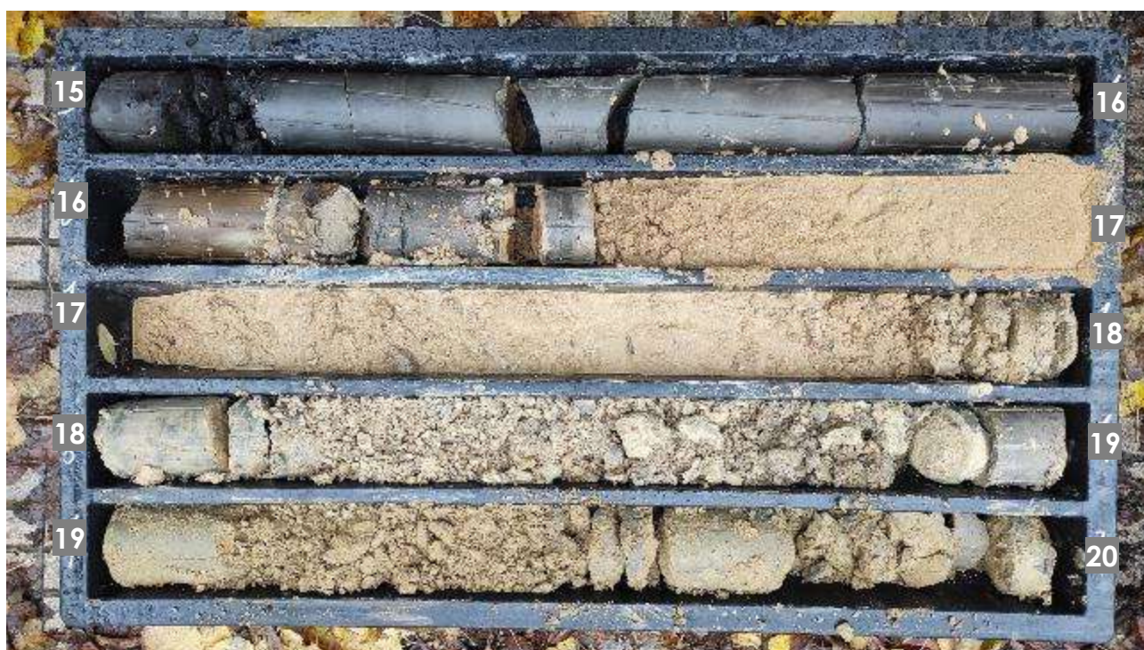
Foto cassetta catalogatrice n.4 Sondaggio geognostico S1 da 15 a 20 m dal p.c..
