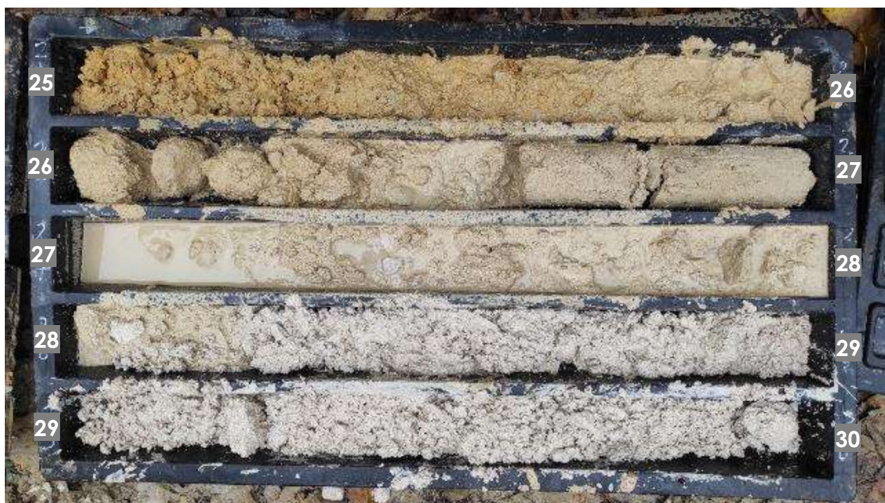
Foto cassetta catalogatrice n.6 Sondaggio geognostico S1 da 25 a 30 m dal p.c..
