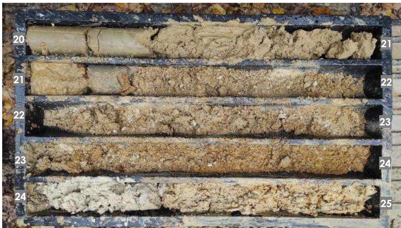
Foto cassetta catalogatrice n.5 Sondaggio geognostico S1 da 20 a 25 m dal p.c..
