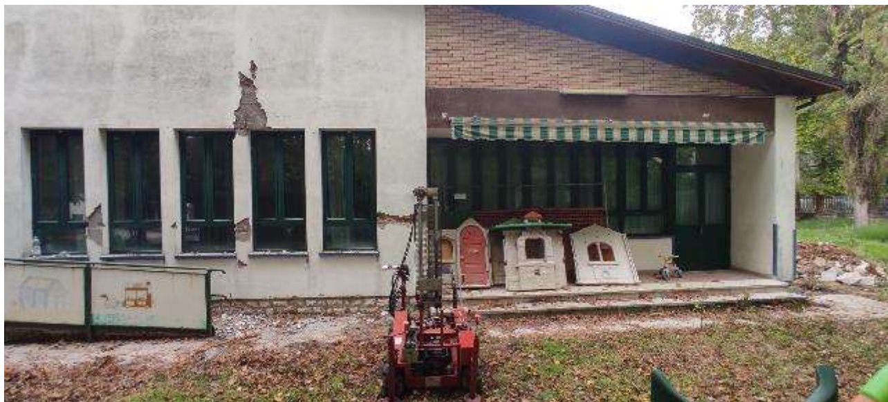
Foto 5. Esecuzione prova penetrometrica dinamica continua P5.
