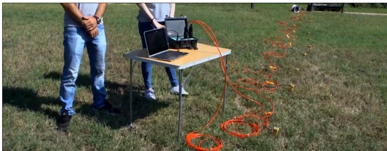
Figura 3. Configurazione strumentazione per acquisizione con sismografo GEA24.
